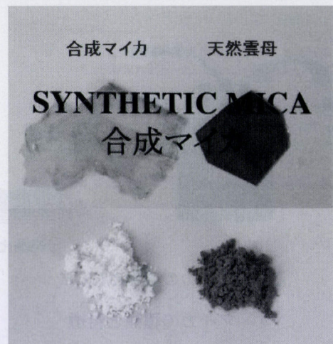
図5 合成マイカと天然雲母（金雲母）の色の違い 上) 単結晶, 下) 粉末
